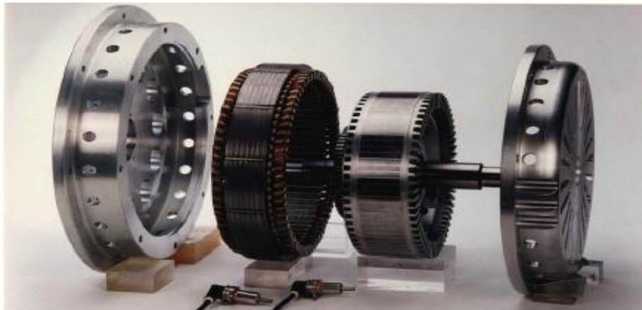
Asynchronmotor für Hybridfahrzeug (IFe = 45 mm; d = 250 mm; PN = 12 kW)
